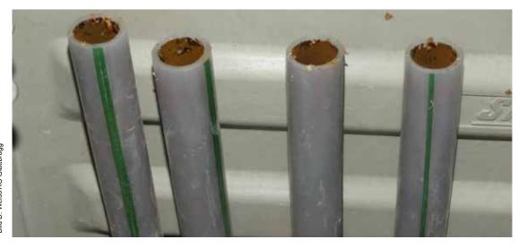
Verschlammte und verrostete Rohre und Heizsysteme können mit der richtigen Wasserqualität vermieden werden.
