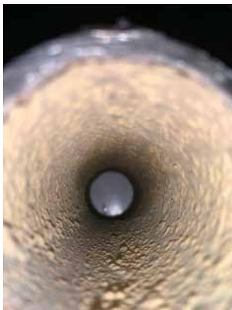
Bild 2: Schutzschichtaufbau durch Silikat-Behandlung
