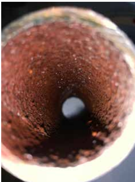
Illustration 1: sans traitement au silicate
